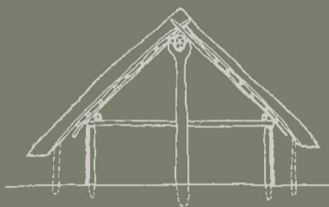
Querschnitt eines Langhauses, rekonstruiert – mit einer Dachdeckung aus Ried oder Stroh, einer Dachneigung von 45 Grad und einer Wandhöhe von 1,8 bis 2 m.
